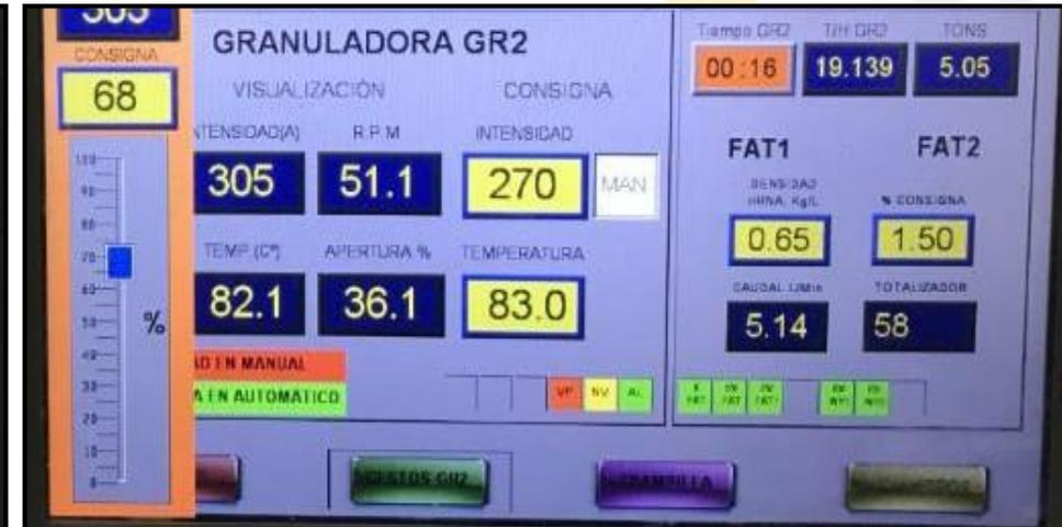
A una intensidad de máquina de 305 A, se consigue llevar a 51,1 rpm, consiguiendo una producción de 19139 kg/h
