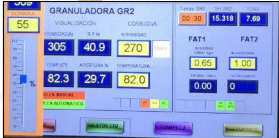
A una intensidad de máquina de 309 A, se consigue llevar a 40,9 rpm, consiguiendo una producción de 15318 kg/h
