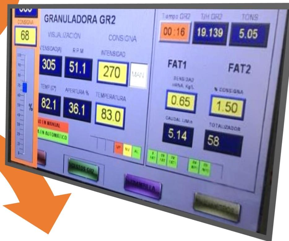
A una intensidad de máquina de **305 A**, se consigue llevar a **51,1 rpm**, consiguiendo una producción de **19139 kg/h**
