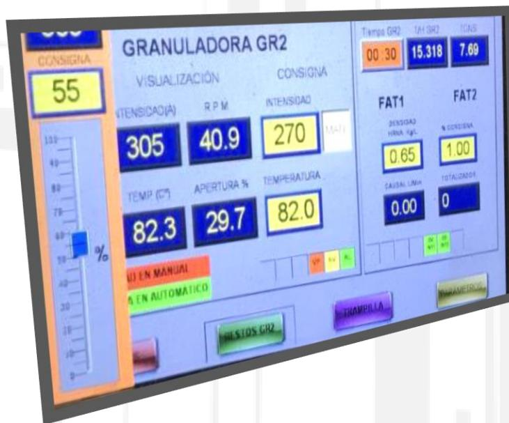
A una intensidad de máquina de **309 A**, se consigue llevar a **40,9 rpm**, consiguiendo una producción de **15318 kg/h**
